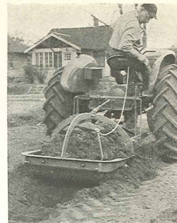
Muldsluffe monteret bagpå traktoren
