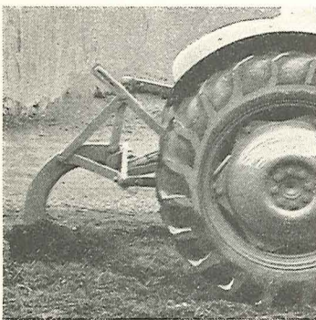
Traktor-grubberen anvendes til opbakning af veje. Den er ophængt i tre-punktssystemet, idet man herved opnår den største mobilitet og trækraft.
